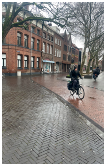
Contrastrijke verhardingen markeren de zones voor verschillende weggebruikers.
